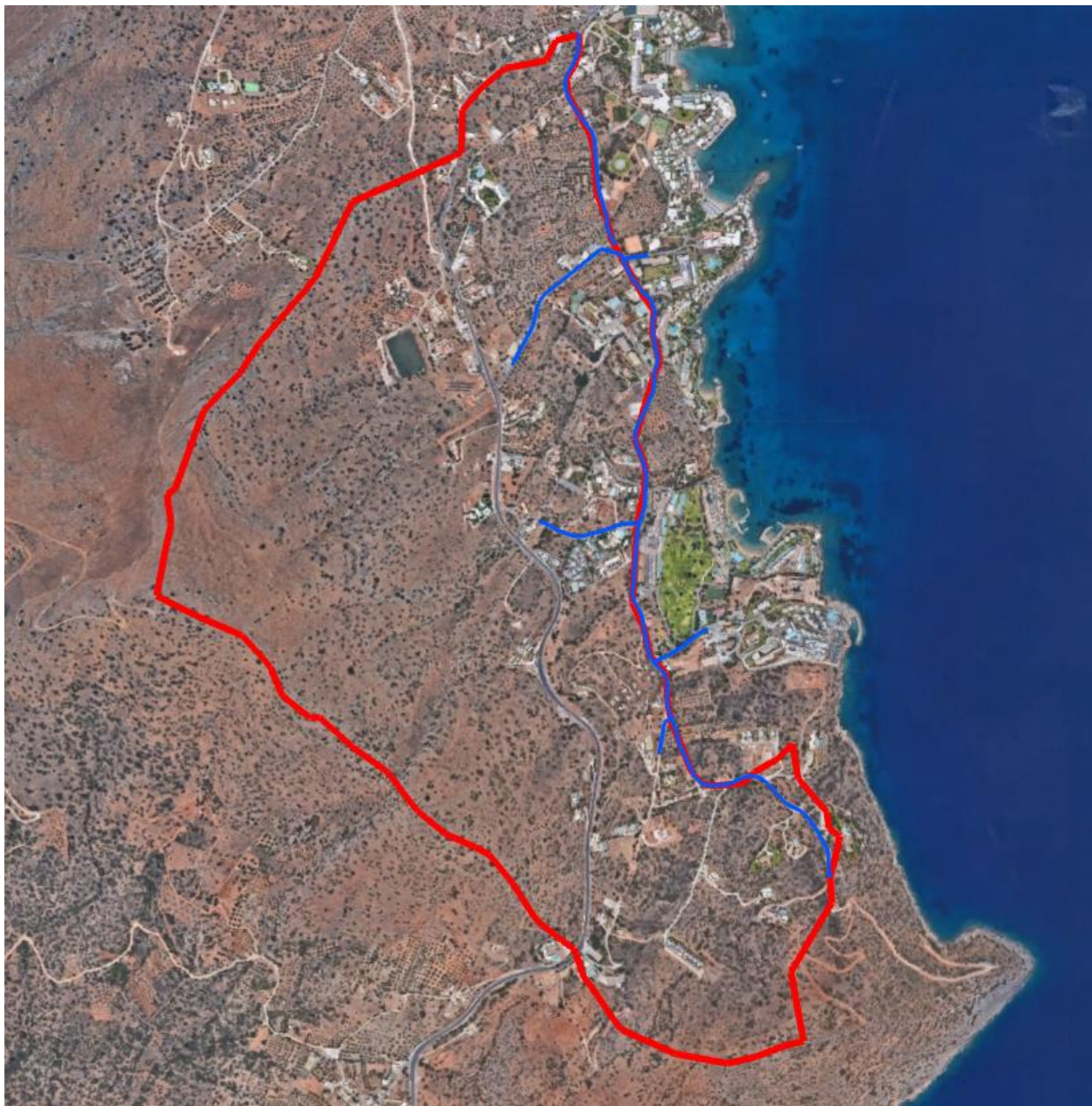
Σχήμα 4-1 Σχηματική απεικόνιση συνολικής εξωτερικής λεκάνης απορροής του υπό αποτίμηση των υδραυλικών του παραμέτρων τμήματος δρόμου
