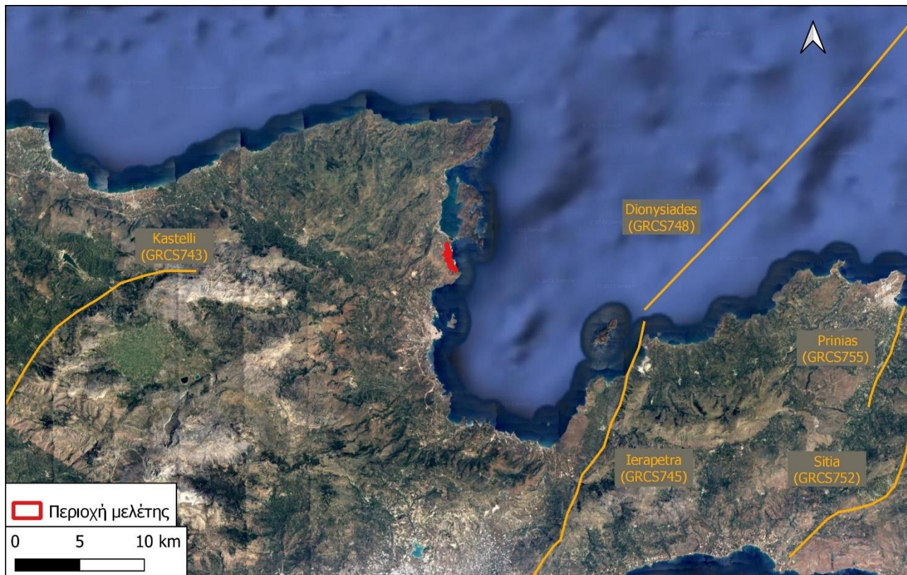
Σχ. 4.3 – Σεισμογενή ρήγματα πέριξ της περιοχής μελέτης σύμφωνα με την Ευρωπαϊκή Βάση Δεδομένων Σεισμογενών Ρηγμάτων (Basili et al., 2013)
