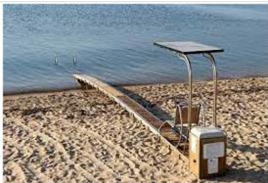
Εικόνα 37: Σύστημα διευκόλυνσης ΑΜΕΑ για είσοδο στη θάλασσα
