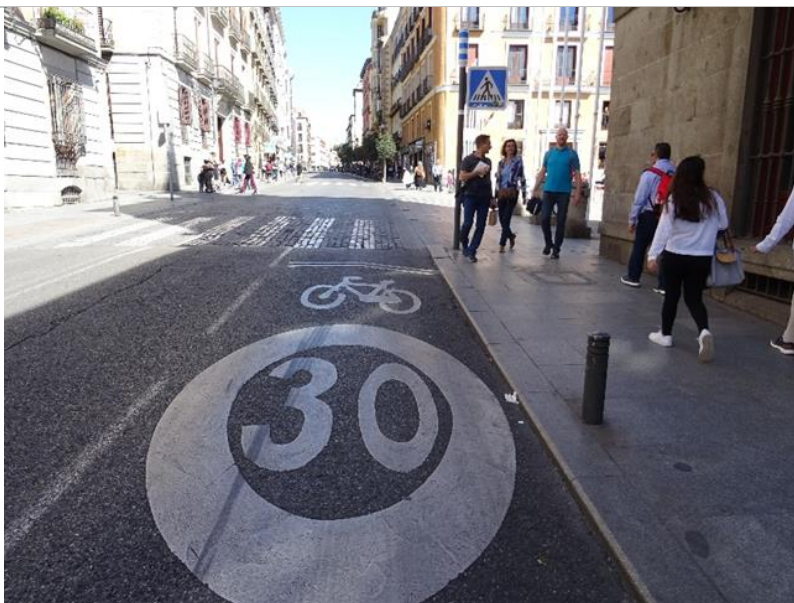
Εικόνα 33: Λωρίδα ποδηλάτου μικτής χρήσης και με όριο ταχύτητας 30 km/h για ασφαλή συνύπαρξη οχημάτων και ποδηλάτων.
