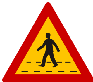
Εικόνα 44 Σήμανση για κίνδυνο λόγω διάβασης πεζών (Κ-15)
