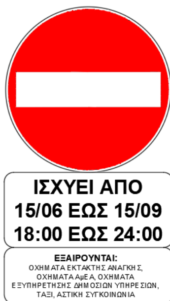
Εικόνα 36 Σήμανση περιοδικής απαγόρευσης κυκλοφορίας οχημάτων (P7)
