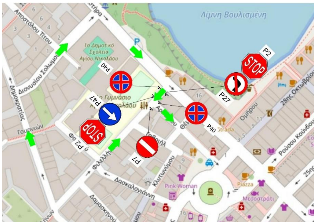
Εικόνα 32 Υφιστάμενη κατακόρυφη σήμανση στην οδό Φιλελλήνων και επιτρεπόμενες κατευθύνσεις
